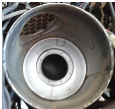
Figura 28: Alojamiento de filtros de admisión
