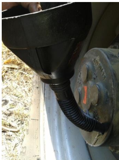
Figura 25: Relleno de aceite en cubo planetario
