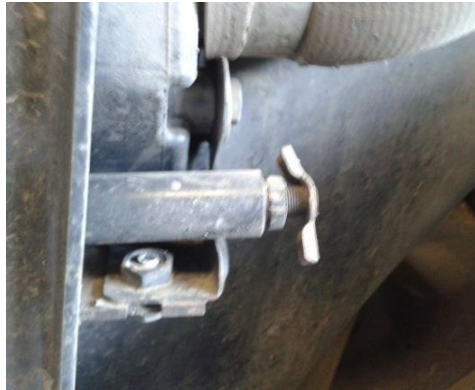
Figura 26: Drenaje de refrigerante
