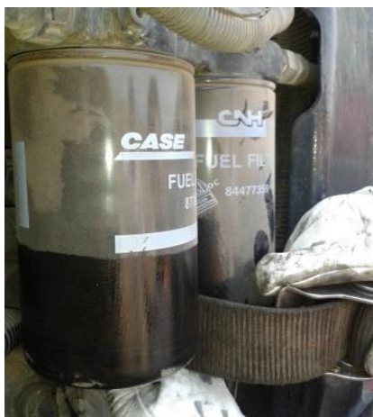
Figura 14: Filtro primario de combustible
