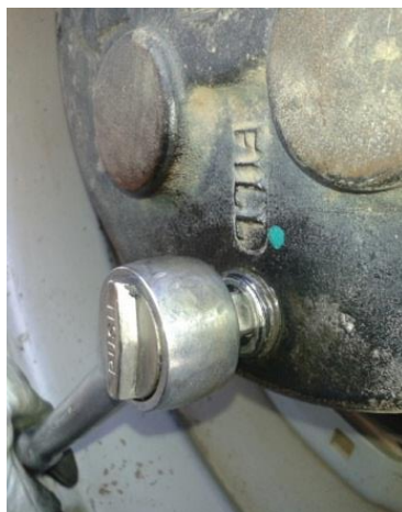
Figura 25: Relleno de aceite en cubo planetario
