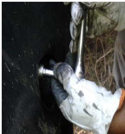
Figura 17: Drenaje de aceite
