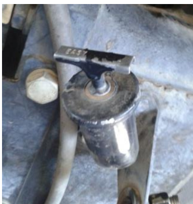
Figura 10: Tapa del depósito de aceite hidráulico.
