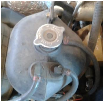
Figura 11: Depósito principal de refrigerante
