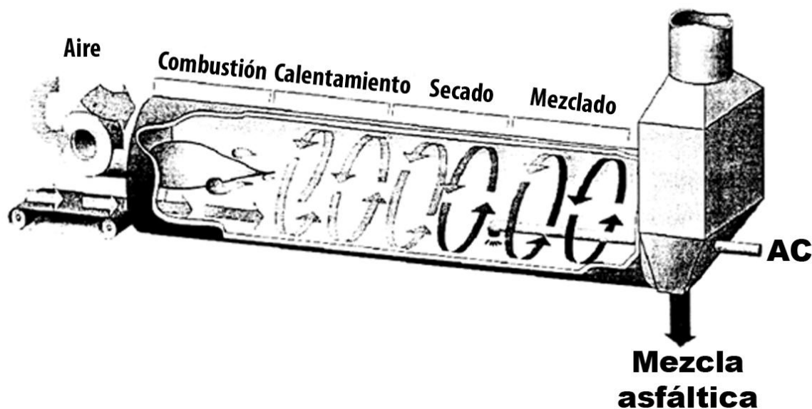
Ilustración 22. Procesos dentro de un tambor de flujo paralelo.
