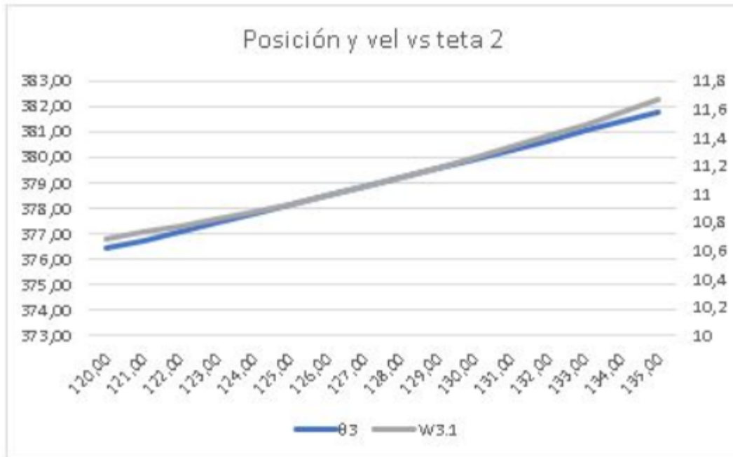
Figura 95: Análisis de posición y velocidad theta 3 y omega 3
