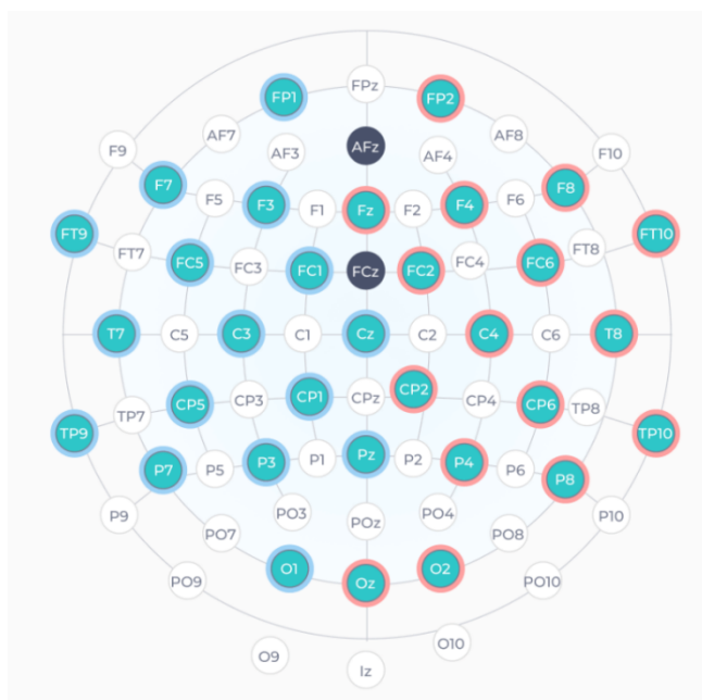
Figura 9 Distribución de los electrodos en el Emotiv Flex
