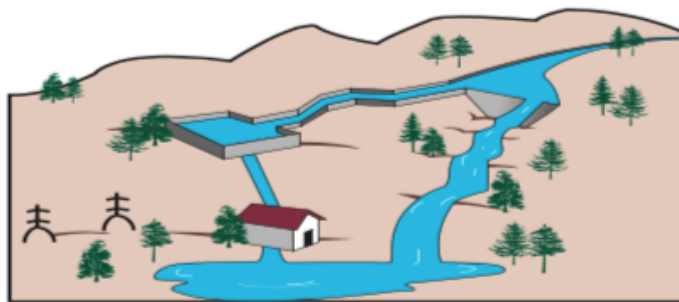
Figura No. 5 Central de agua fluyente
