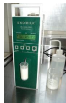
Figura No. 25. Análisis de la composición química de la leche con el "Ekomilk".
