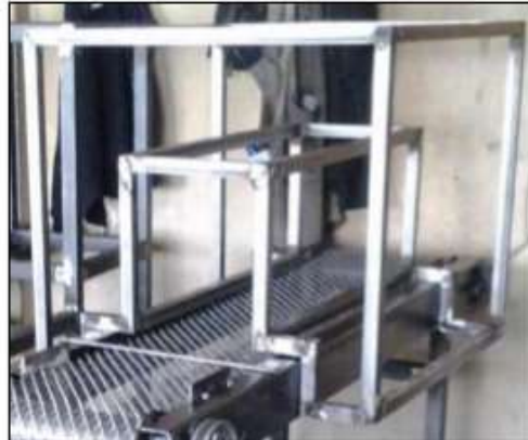
Ilustración 6. Estructura del túnel de termoencogido
