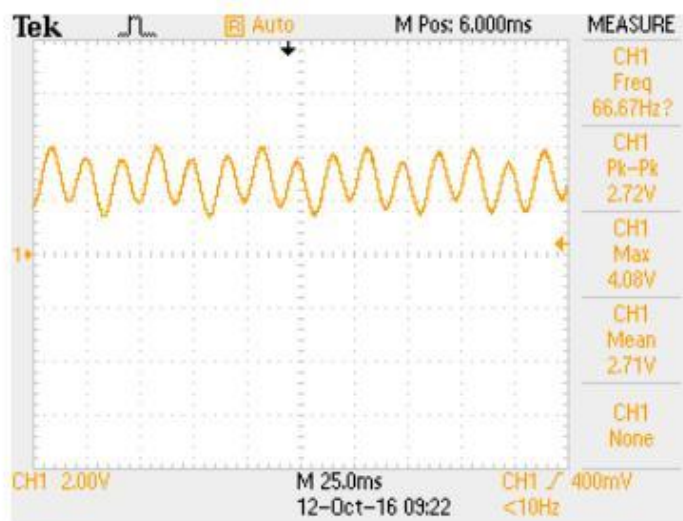
Figura 72. Señal de 60 Hz de 1 Voltio de amplitud sumada a señal de 22 Hz de 0.5 Voltios de amplitud.
