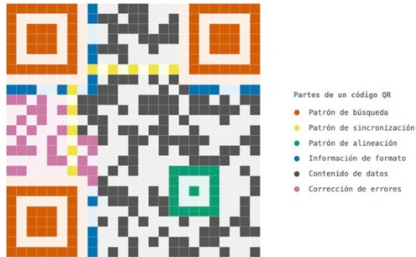
Figura 4. Esquema del funcionamiento de los códigos QR [25]
