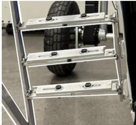
Figura 44. Sistema de ajuste mediante ranuras
