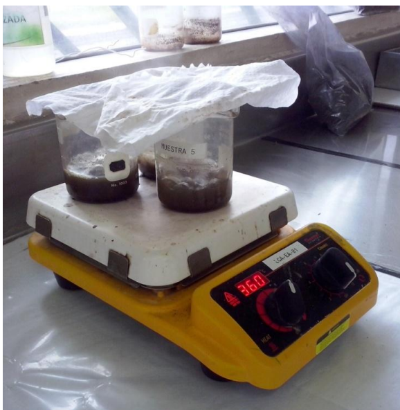
Figura No. 17: Proceso de calentamiento de la solución buscando evaporar el agua de la misma, en el laboratorio de caña del Ingenio Magdalena.
