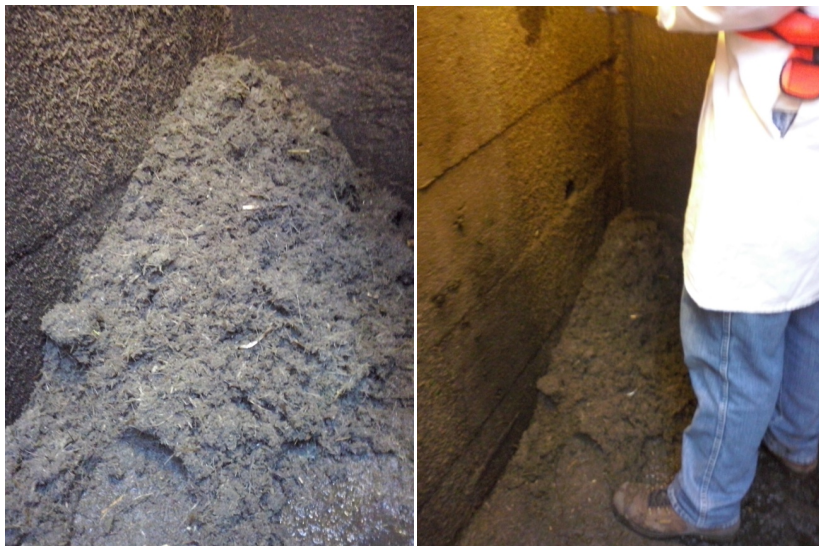
Figura No. 45: Acumulación de bagacillo para hacer el estudio disminución de sacarosa.
