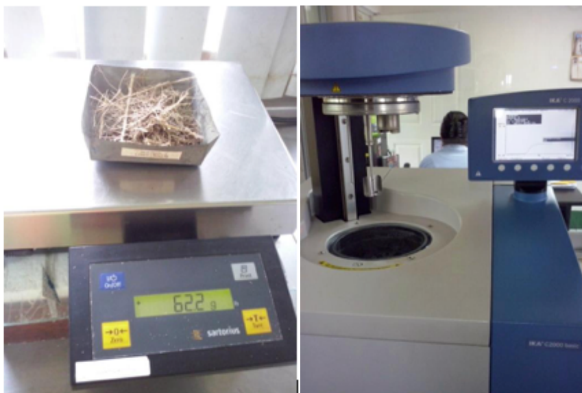
Figura No. 16: Izquierda: pesado de bagazo seco. Derecha: máquina que obtiene el poder calorífico
