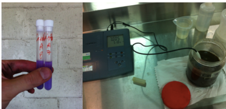
Figura No. 19: Izquierda: tubos de ensayo de resazurina. Derecha: medición de pH para el jugo sulfitado.
