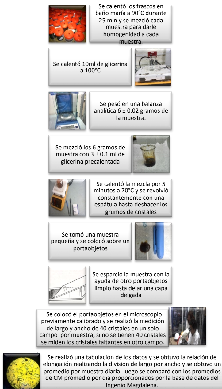
Figura No. 24: Metodología de medición de elongación de cristales de masa C.
