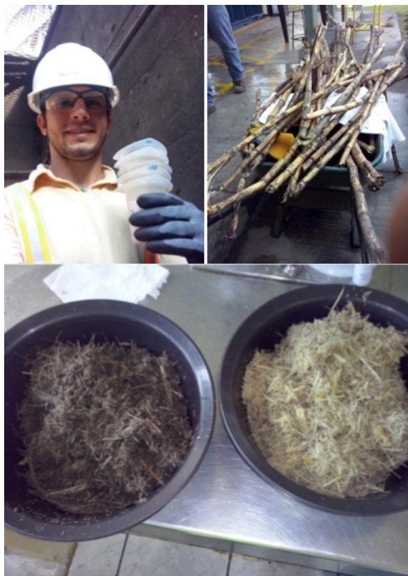
Figura No. 15: Toma de muestra de caña barrida y bagacillo bajo los conductores.
