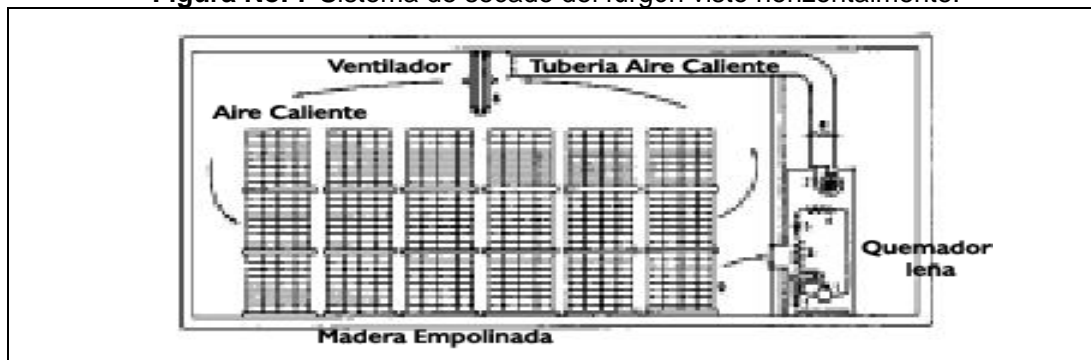
Figura No. 7 Sistema de secado del furgón visto horizontalmente.
