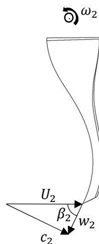
Fig. 5: Triángulo de velocidad a la salida del impulsor
