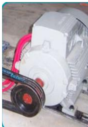
Ilustración 58. Generador de inducción.
