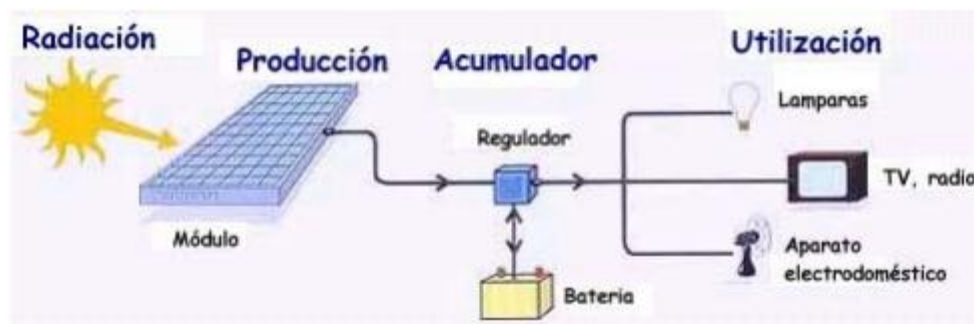
Ilustración 10. Generación de energía eléctrica fotovoltaica
