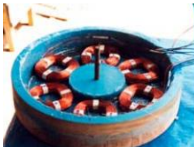
Ilustración 59. Generador de imanes.
