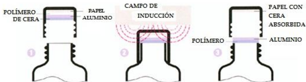
Figura 12: Principios del sellado por inducción
