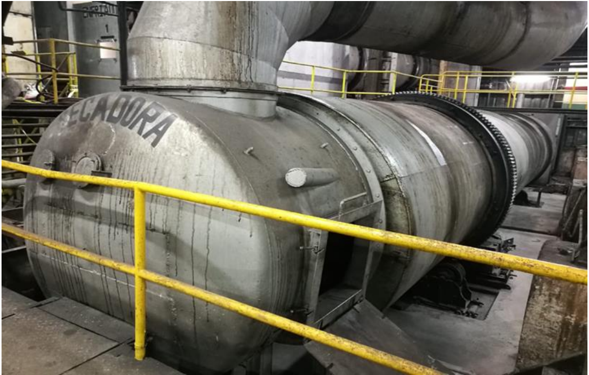
Figura No 14. Secadora salida de aire
