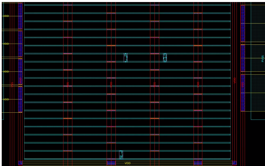
Figura 37: Placement y legalización de celdas estándar en ICC2
