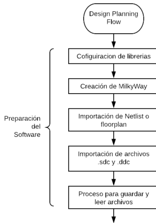
Figura 7: Primera etapa de la síntesis física. Preparación del software. [10]
