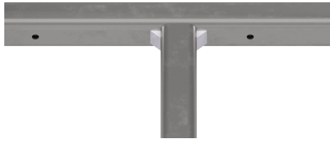
Figura 90: Vista superior del segundo patrón de la soldadura
