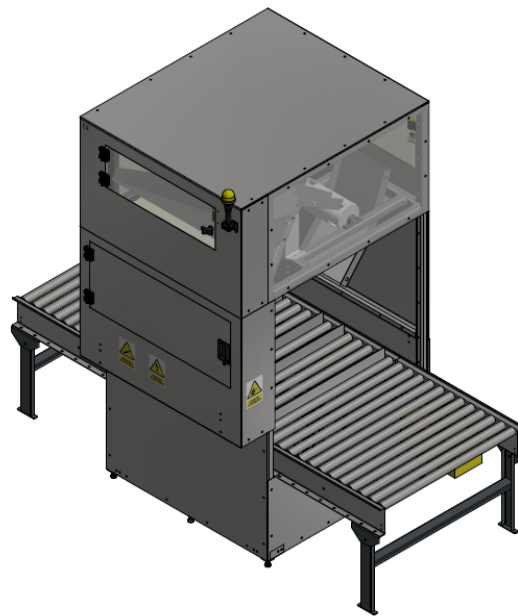
Figura 2.3: Vista lateral de la máquina completa con banda transportadora
