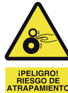
Figura 1.2: Advertencia de la presencia de peligros debido a la banda transportadora
