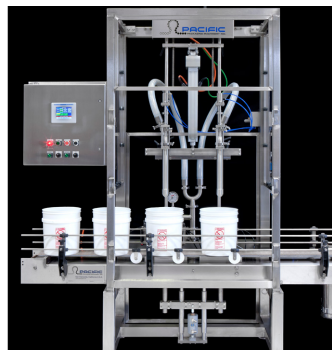
Figura 3: Máquina completa donde se muestra el cilindro neumático que levanta la cubeta
