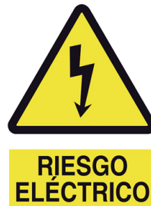
Figura 102: Advertencia de la presencia de peligros debido a la utilización de sistemas eléctricos
