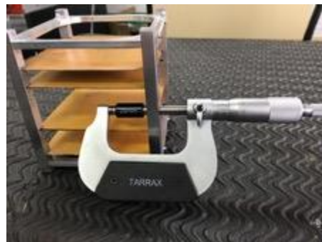
Figura 59. Medición con micrómetro
