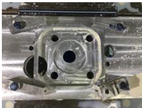
Figura 54. Montaje para maquinado de características internas
