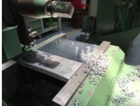
Figura 50. Preparación de material para maquinado final
