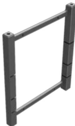
Figura 20. Pieza lateral de estructura primaria
