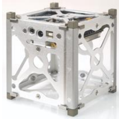
Figura 4. Estructura de monocasco de Pumpkin Inc.
