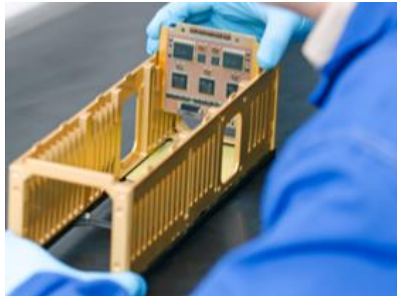
Figura 6. Estructura basada en tarjetas de Complex Systems and Small Satellites
