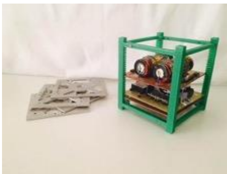
Figura 49. Prototipo de estructura impreso en 3D
