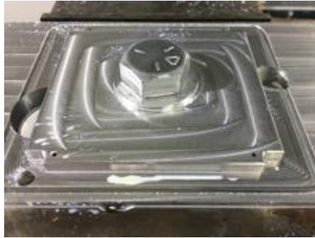
Figura 52. Montaje para fabricación de características externas
