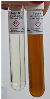
Figura 52. Comparación colorimétrica de solución preparada con extracto de levadura (derecha) y blanco (izquierda) para análisis de nitrógeno total
