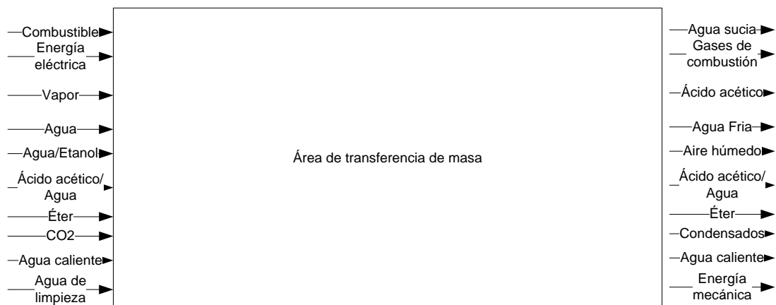
Diagrama No. 11 Diagrama general del área de transferencia de masa
