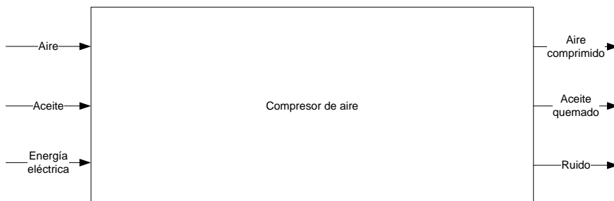
Diagrama No. 7 Diagrama específico del compresor de aire
