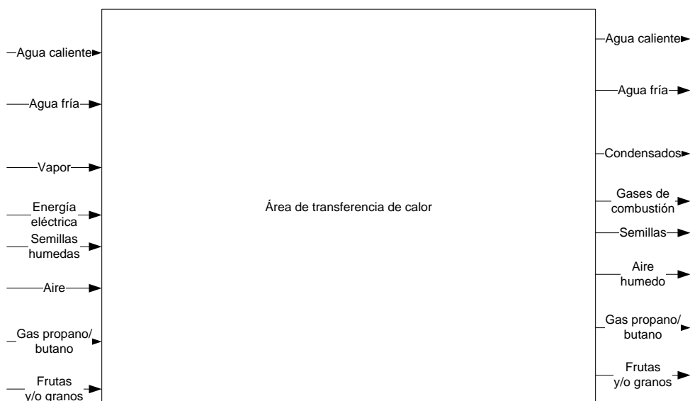
Diagrama No. 4 Diagrama general de área de transferencia de calor
