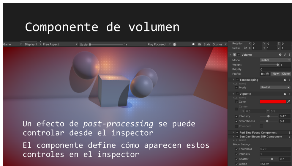
Figura 6.4: Dispositiva 5 de la presentación creada para el tema de creación de efectos de post-processing que muestra el propósito de un componente de volumen, proveer una manera de configurar un efecto de post-processing por medio de controles amigables a usuarios no técnicos.
