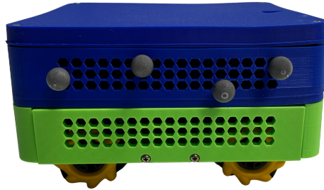
Figura 21. Ubicación de los marcadores en los laterales de la plataforma
