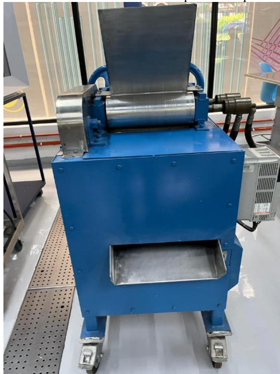
Figura 21. Molino de rodillos utilizado para la etapa de molienda
