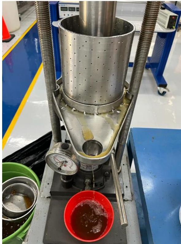
Figura 35. Recuperación del mosto retenido en el grano por medio del uso de una prensa hidráulica
