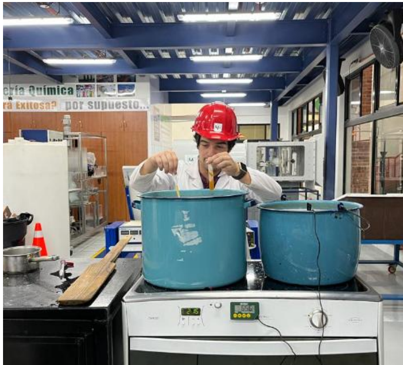
Figura 34. Maceración a escala industrial en dos recipientes de 40 L
