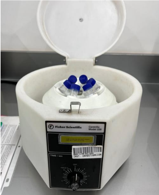
Figura 39. Centrifuga utilizada para la preparación de muestras que se enviaron a HPLC
