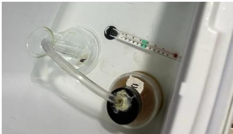
Figura 27. Sistema fermentativo en la etapa de fermentación en un recipiente aislado
