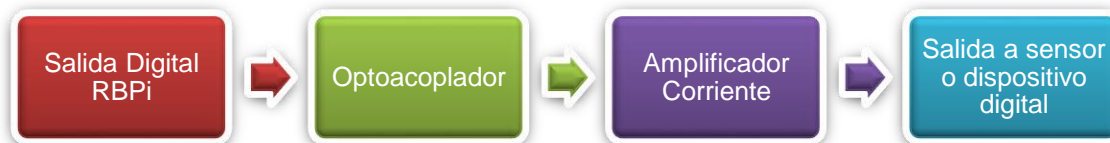
Figura 17. Diagrama de circuito de acondicionamiento para salidas digitales.
