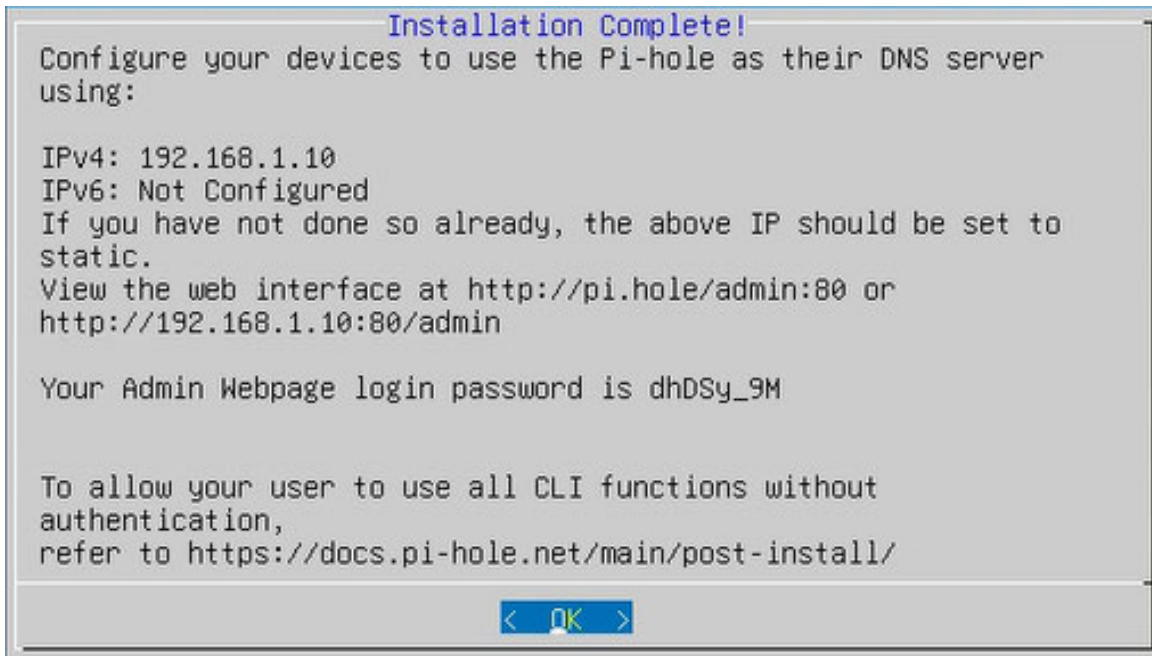
Figura 92. Resumen de la configuración de Pi-hole al finalizar la instalación.
