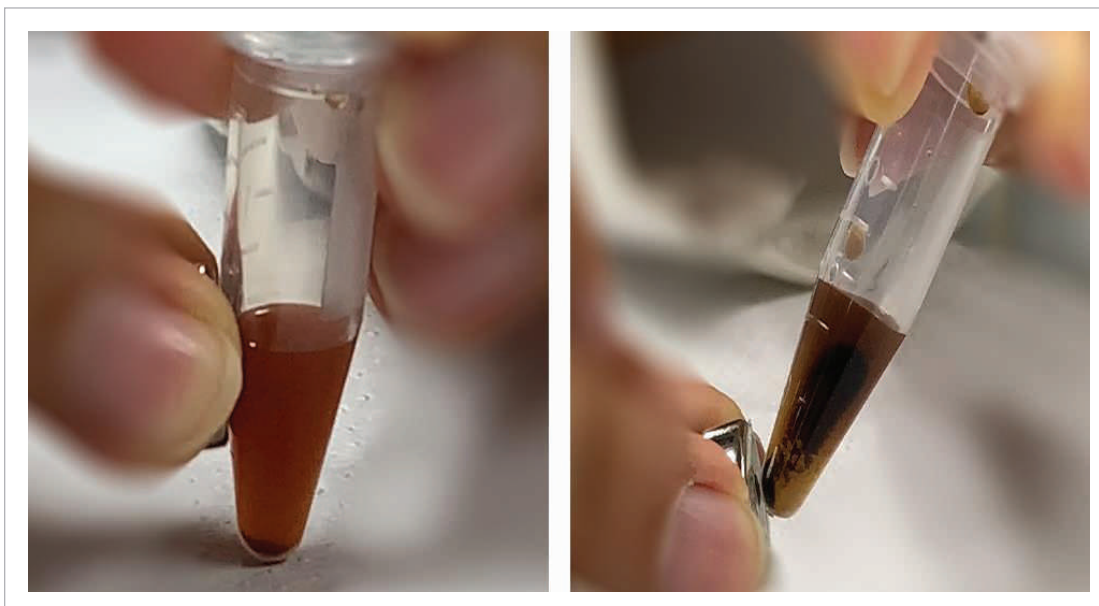
Figura 1. (izquierda) precipitado del control negativo sin atracción por el imán, (derecha) precipitado de la muestra 1 que es atraído por el imán.
