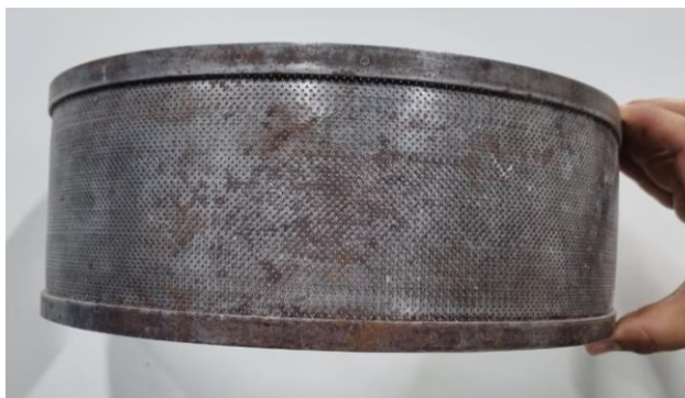
Figura 47. Segundo Criba para molino de martillo utilizado para la molienda de maíz
