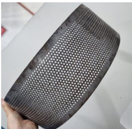
Figura 47. Segundo Criba para molino de martillo utilizado para la molienda de maíz
