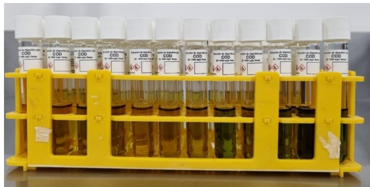
Figura 30. Viales para determinación de demanda química de oxígeno
