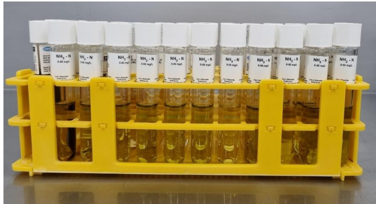
Figura 28. Viales para determinación de concentración de amonio
