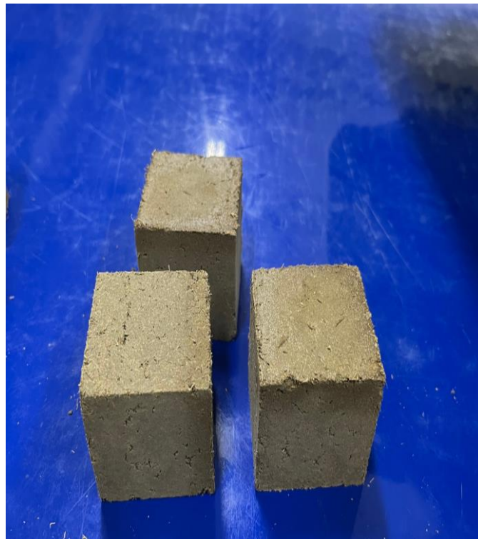
Figura 58: Morteros de cemento celular luego de desmoldar
