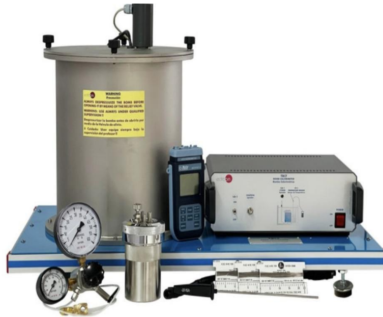
Figura 13: Bomba calorimétrica y sus partes
