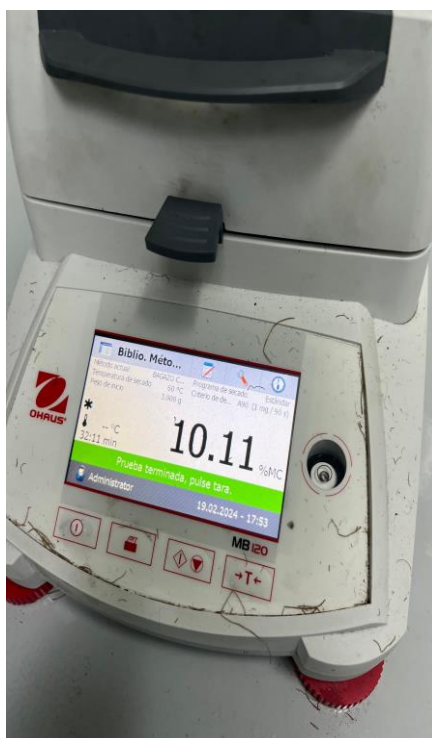
Figura 52: Porcentaje de humedad inicial de la fibra de palma obtenido por medio de la balanza de humedad
