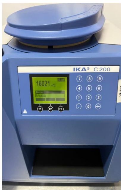
Figura 53: Prueba de la capacidad calorífica por medio de la bomba calorimétrica IKA
