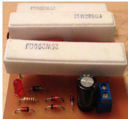
Fig. 41. Placa de fuente de alimentación terminada.
