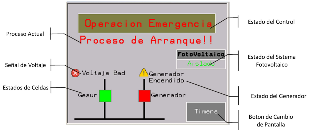
Figura 27. Pantalla principal HMI
