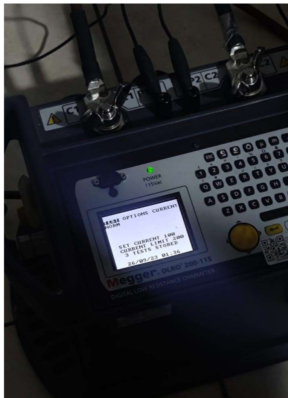
Figura 37. Realización de pruebas de resistencia en fusibles
