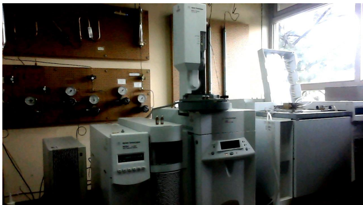
Figura No. 5 Cromatógrafo utilizado para analizar las muestras de aguarrás obtenidas en las destilaciones
