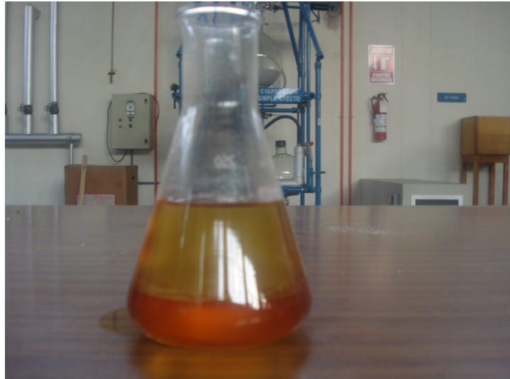
Figura 11: Separación de fases biodiesel glicerina
