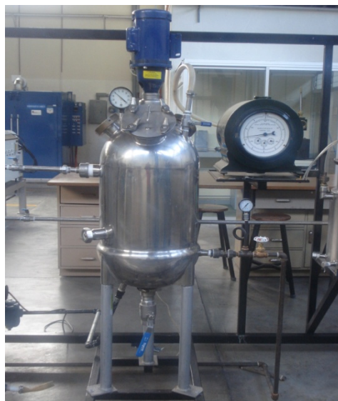
Figura 6: Reactor donde se produce la reacción de transesterificación
