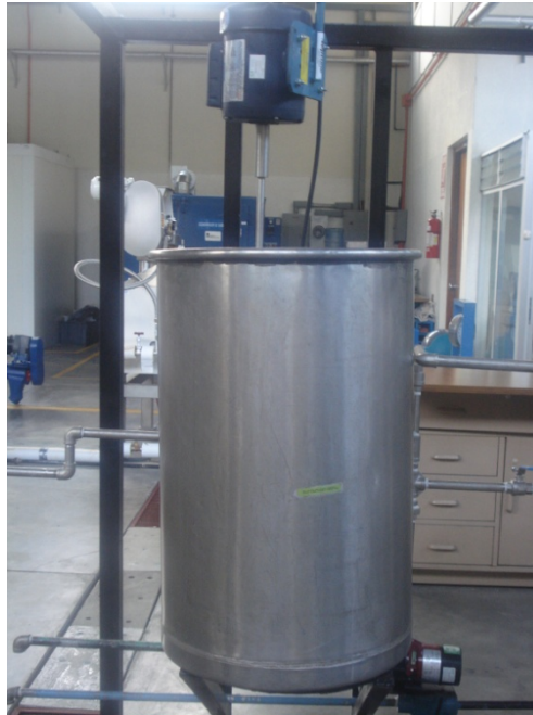
Figura 5: Tanque para preparación de metóxido de sodio
