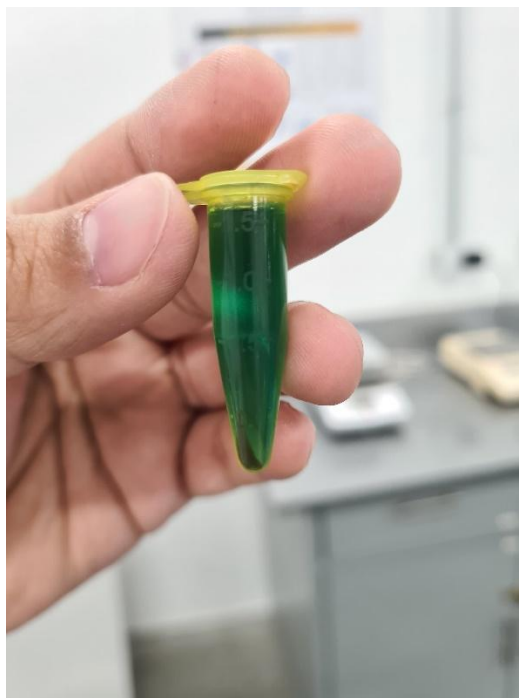
Figura 25: Precipitado de óxido de cobre en determinación de carbohidratos en pulpa
