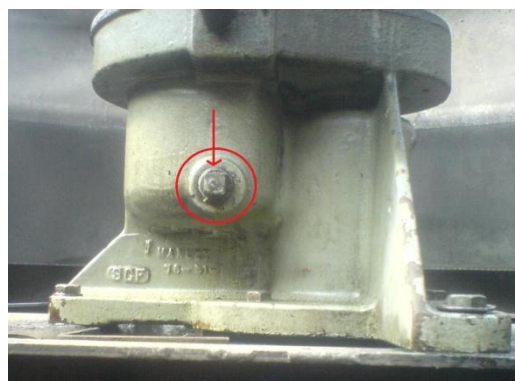
Ilustración No. 60. Punto de lubricación del motoreductor
