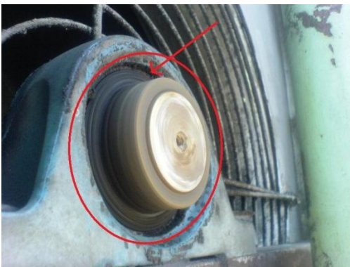
Ilustración No. 58. Puntos de lubricación de las chumaceras exteriores
