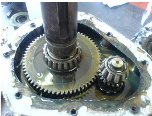
Ilustración No. 45. Verificar la holgura entre los engranes
