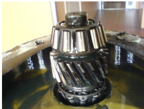
Ilustración No. 44. Verificar el desgaste del piñón
