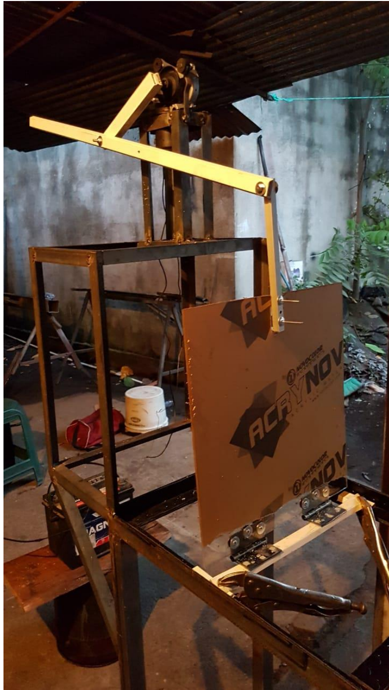
Figura 31 Construcción del sistema mecánico biela-manivela y la paleta generadora de olas
