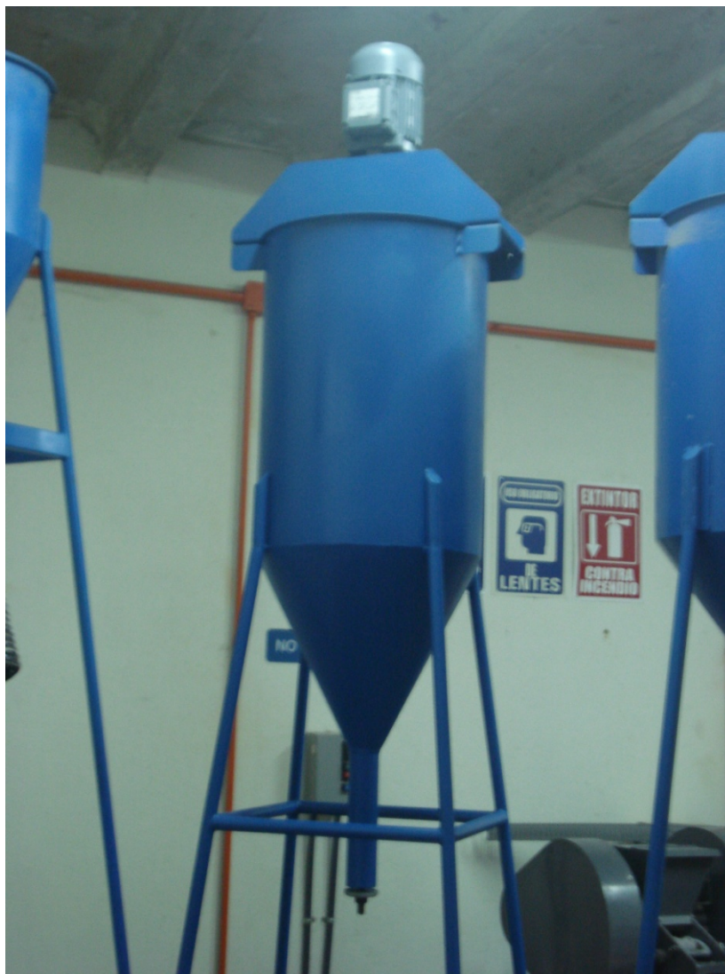
Figura 29. Imagen del Silo 2 con su tornillo dosificador.
