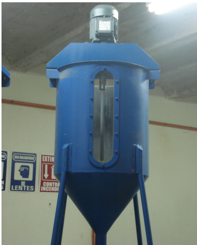
Figura 28. Imagen del Silo 1 con su tornillo dosificador.
