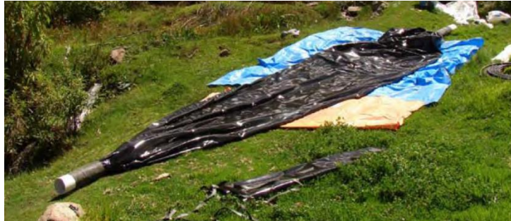
Figura 27. Reactor con tubos de entrada y salida
