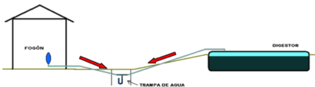
Ilustración No.23: Trampa de agua en punto bajo de la tubería
