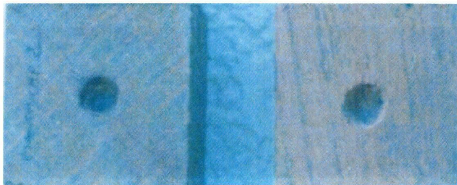
Foto MN4. Fallas causadas por la prueba de dureza Janka, axial y lateral respectivamente
