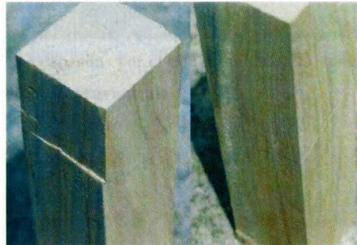
Foto PB2. Fallas causadas por compresión paralela a la fibra
