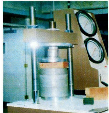
Foto 7. Diseño para la prueba de compresión perpendicular a la fibra
