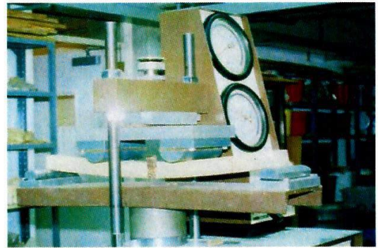
Foto 5. Diseño para la prueba de ruptura
