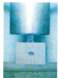
Foto 9. Diseño para la prueba de dureza Janka
