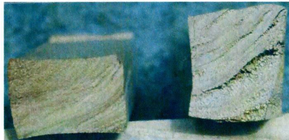
Foto PB3. Fallas causadas por compresión perpendicular a la fibra
