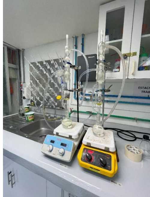
Anexo 13. Equipo de Soxhlet para determinación de contenido de extraíbles.
