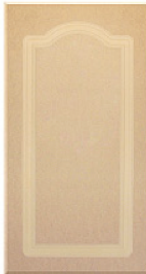
Figura 55. Pieza fabricada en el Router CNC.
