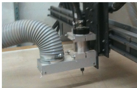
Figura 53. Conexión de la manguera del extractor de viruta.
