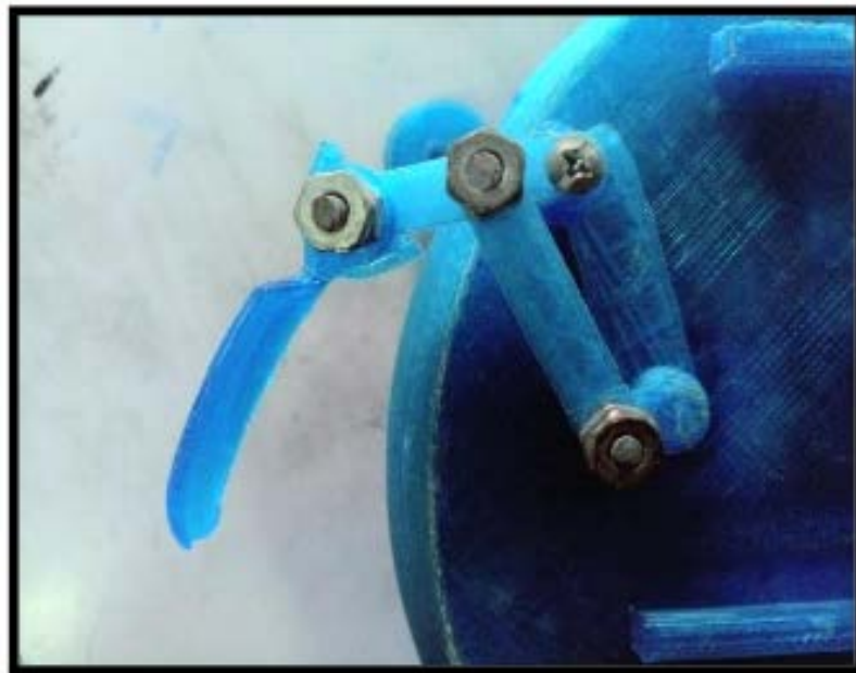
Figura 46: Casco impreso en FDM con material PLA de la fase 1.
