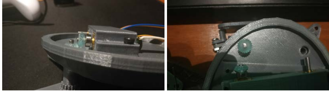
(a) Engranajes desalineados.
