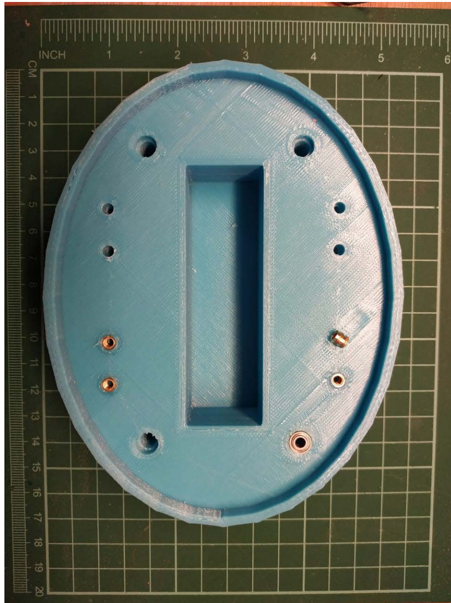
Figura 62: Tuercas insertadas con calor.
