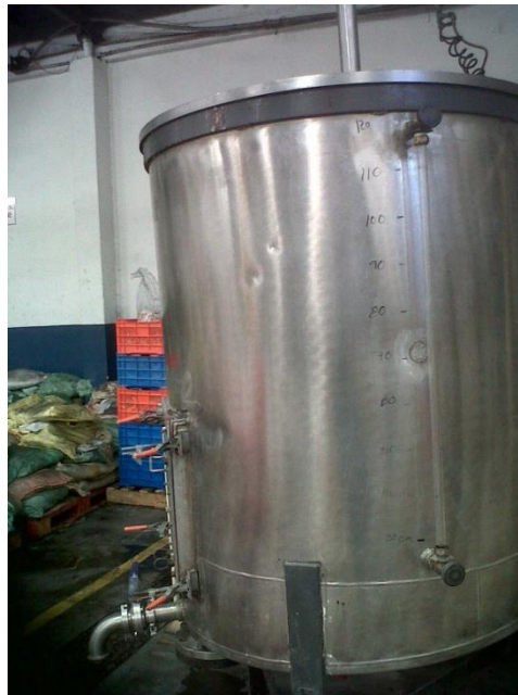
Ilustración 6. Depósito de miel filtrada
