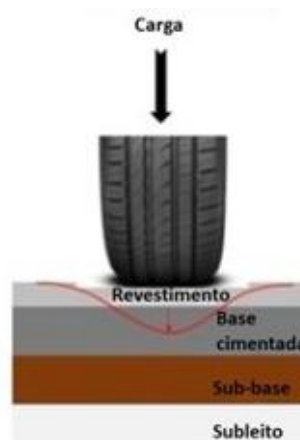
Figura 14. Esquema del comportamiento del pavimento semirrígido Fuente: (Moura, 2023)
