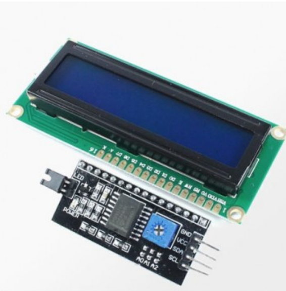
Figura 15: Pantalla LCD I2C utilizada en la implementación de la plataforma de automatización
