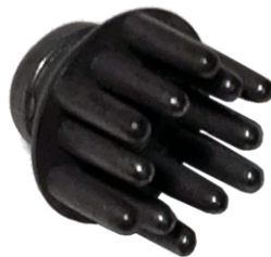
Figura 4: Electrodo fabricado en impresora 3D recubierto con pintura conductiva.
