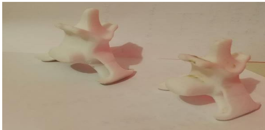
Figura 29. Vértebras impresas en PLA previo a el tratamiento impermeabilizante.
