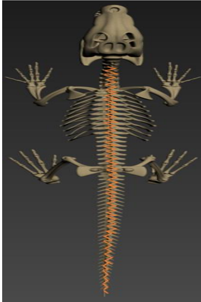
Figura 39. Diagrama de distribución de resorte que emula columna vertebral.
