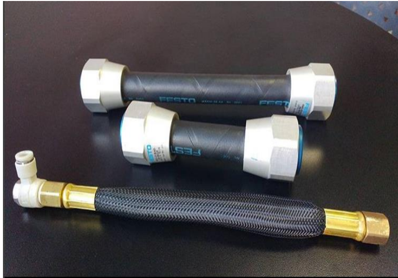
Figura 42. Comparación músculos neumáticos y actuadores neumáticos flexibles.
