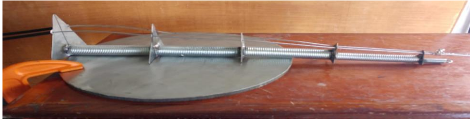
Figura 35. Prototipo de cola del cocodrilo con sistema de cables tensores acerados.
