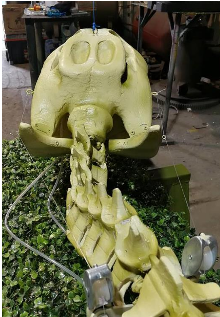
Figura 37. Hilos tensores para el movimiento del cráneo
