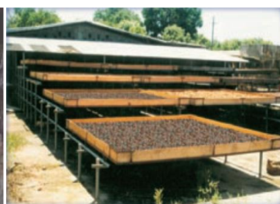
Secador de plataformas móviles
