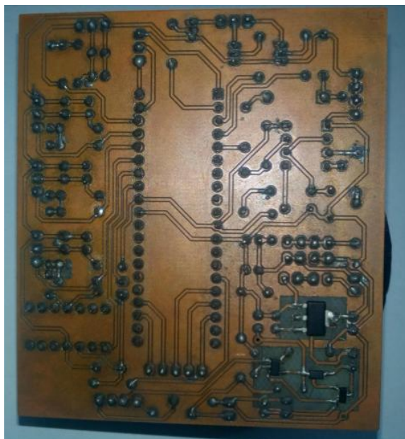
Figura 63: Vista inferior de la placa impresa del circuito principal del dispositivo esclavo
